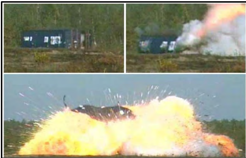
תמונה 2. ניסוי CHAF לפגזי 75 מ"מ (קבוצת סיכון 1.3) - "כדור אש" (מקור 17)
