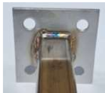
לאחר טיפול כללי ב-ג'ל D-100 לבן: ניקוי כלל השטח (מכתמי חלודה ותחמוצות)
