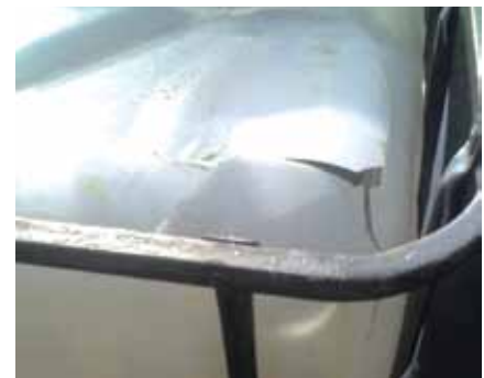
תמונה 4: קובייה שפג תוקפה - מעטפת הפלסטיק של הקובייה הופכת להיות שבירה
