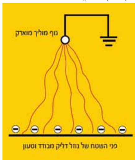
תרשים 2: מנגנון היווצרות פריקת מברשת (פריקה מפני השטח של נוזל מבודד לגוף מוליך מוארק)
