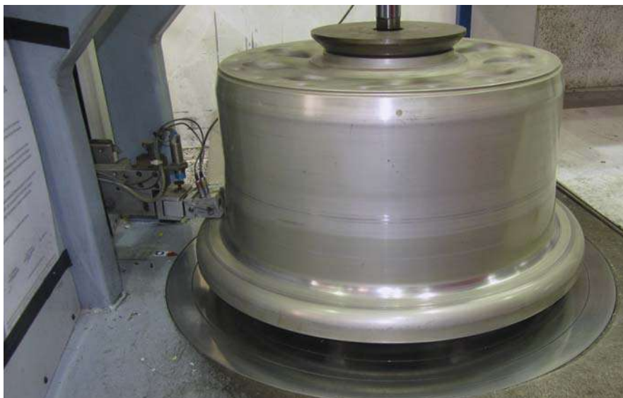
למעלה: המערכת הכוללת לבדיקה בשיטת זרמי ערבולת. למטה: גלגל במהלך בדיקה עם זוג גשישים.
