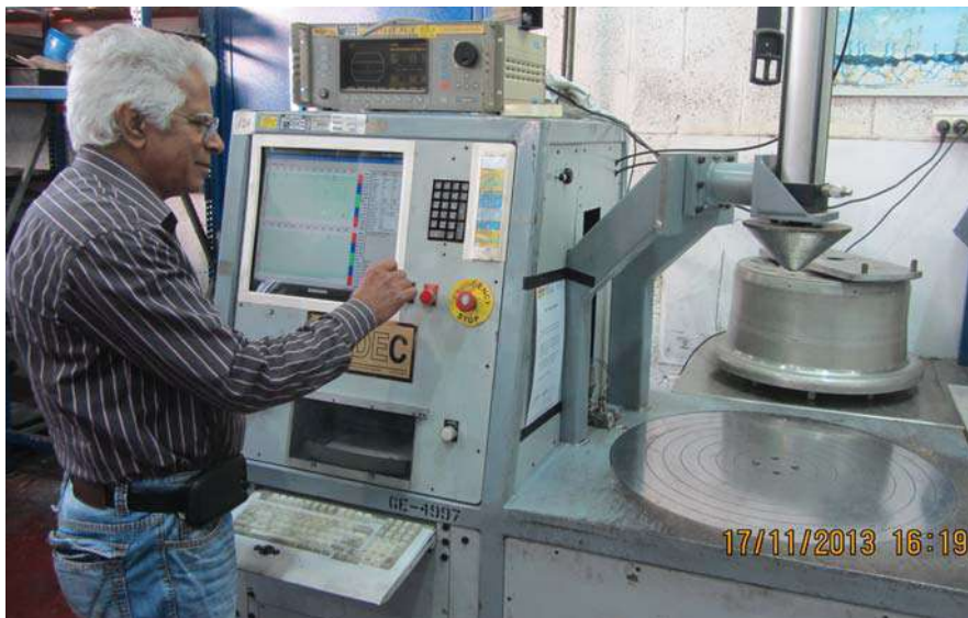
למעלה: המערכת הכוללת לבדיקה בשיטת זרמי ערבולת. למטה: גלגל במהלך בדיקה עם זוג גשישים.
