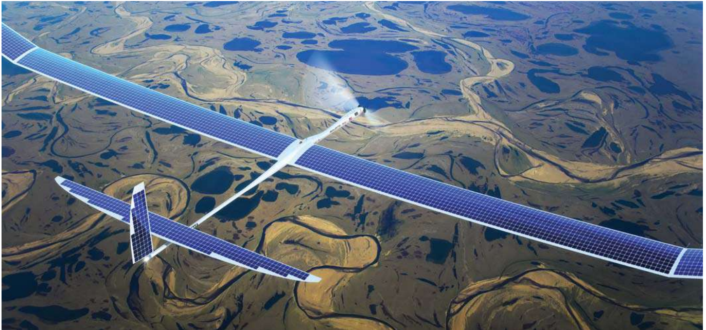
חברת טייטון איירוספייס מפתחת כיום בארה"ב כטב"ם סולארי בעל מוטת כנף של 50 מטר, שיוכל לשהות באוויר במשך שבועות ויהווה תחליף ללוויין קטן.
