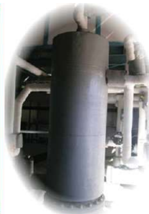
מתקן לאגירה תרמית במלח מותך. פותחה אפליקציה לשיפור מעבר החום לתוך המלח המותך, ונבנה מתקן להוכחת היעילות הטכנולוגית.
